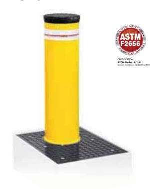
Borne escamotable hydraulique conçues pour une utilisation intensive et recommandées pour la protection des sites spéciaux et de toutes les zones où est demandée un niveau élevé de sécurité et de protection du périmètre contre les attaques terroristes. Une seule TALOS M50 a passé avec succès le crash test ; elle a pu résister à l'impact d'un camion de 7,5 t à une vitesse de 80 km/h en restant intacte et fonctionnelle.
