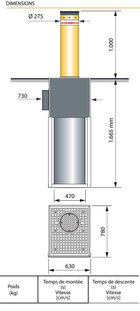
Diamètre colonne 275 mm Code **Epaisseur** Contrainte Finition Hauteur article (mm) (mm) (mm) (\*) 9690L 1000 20 770 (~5,0) [20] (~3,2)[31]
